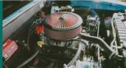
エンジンは、350ci V8クワッドキャブター、BlackBook製インテグリスボディパネルと、同社製5000rpmキープレター、Fuelmaster製ヘッドレス、Fuelmaster製マフラーがセットアップされ、イデオンコンパニオンシステムはMIDで後付けされている。真・エアコールドVentage Airのキットが採用されており、コンピュータ制御でドラッグタイムコントロールも備わっている。
