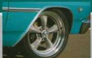
ホイールは、American Racingの714のエアロ20インチのホイール。タイヤは、PirelliのP Zero Rの225-45R20のタイヤが採用されている。このように60年代から存在したタイヤを大切にするアイデムは重要な要素のひとつで、このスタイルにも受け入れられるタイヤは少ない。タイヤは、PirelliのP Zero Rの225-45R20のタイヤが採用されている。タイヤは、PirelliのP Zero Rの225-45R20のタイヤが採用されている。
