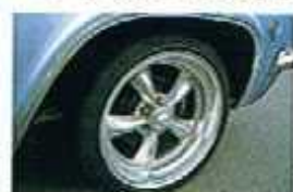
↑ホイールはF16インチ、R20インチのトルクトラスト履き。オールドカーに大径ホイールを履かせることもはや安価化してきた
