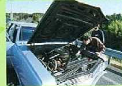
電圧計が異常を示して緊急停車。もしかしてオルタネーターの不調かとドキドキさせるが、なんてことない配線の接触不良でひと安心。もちろん納車時にはきちんと整備するのでこのあたりも問題なし。エンジン&ミッションは絶好調だし、又切なしのクオリティ
