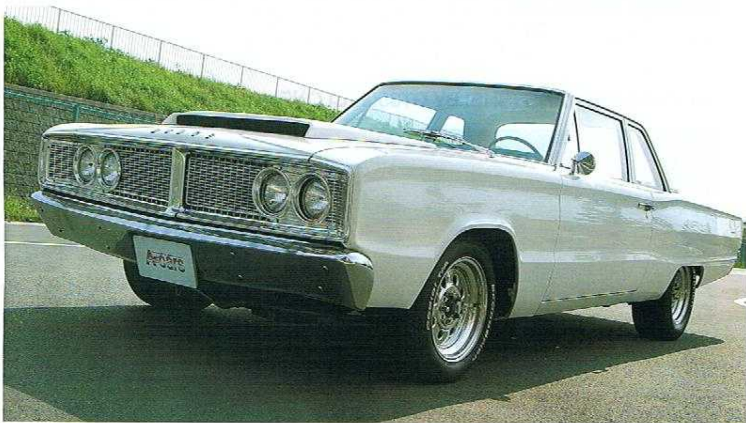
ホイールは、ドラッグレースではおなじみのWeld。ストリートではこのようにキワドリターへのラジアルタイヤを組み合わせているが、レース場ではリザイヤタイヤをドラッグスリックに置き替えて出場、なんて方法もありではないだろうか。
