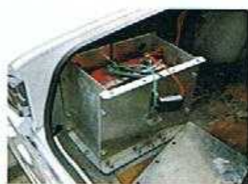
細かな部分ではあるが、バッテリーがトランクルームにリロケーションされているところも重要なポイント。これは駆動するリアタイヤにより多くの荷重をかけてトラクションを得やすくするための対策であり、Street Stripのモディファイにおける王道といえる部分。
