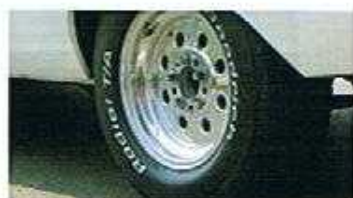
ホイールは、ドラッグレースではおなじみのWeld。ストリートではこのようにキワドリターへのラジアルタイヤを組み合わせているが、レース場ではリザイヤタイヤをドラッグスリックに置き替えて出場、なんて方法もありではないだろうか。
